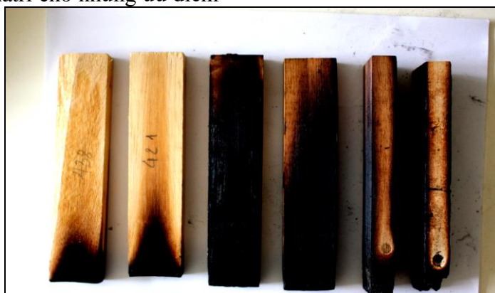
Hình ảnh mẫu thử chống cháy - mẫu có khả năng chống cháy, không bị cháy lan (1); mẫu bị cháy lan trên bề mặt (2) nhưng không bị lửa xâm nhập sâu (3)
