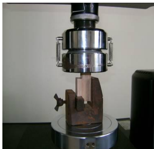
Hình 1. Gá lắp mẫu thử trượt
