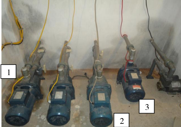
Hình 9: Các loại máy bơm được nghiên cứu thí nghiệm 1- Bơm B1: 220V, 1,5 Hp, H_{max} = 52 \text{ mH}_2\text{O} 2- Bơm B2: 220V, 1,5 Hp, H_{max} = 33 \text{ mH}_2\text{O} 3- Bơm B3: 220V, 1,5 Hp, H_{max} = 22 \text{ mH}_2\text{O}
