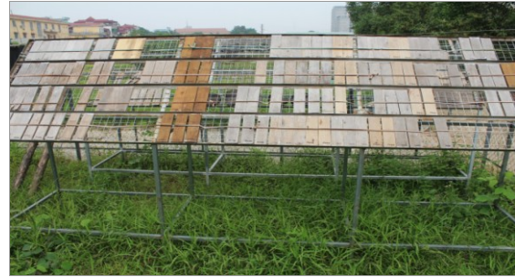
Hình 1. Thí nghiệm phơi mẫu ván dán ngoài trời
